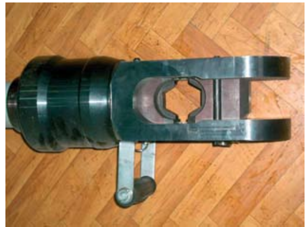
Рисунки 16 Элемент обжимной части установки СПРУТ. Элемент обжимной части установки СПРУТ показан на рисунке 16.
