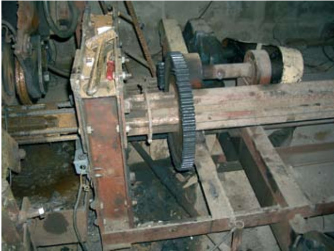
Рисунок 5 Съемный барабан, установленный на силовой раме.
