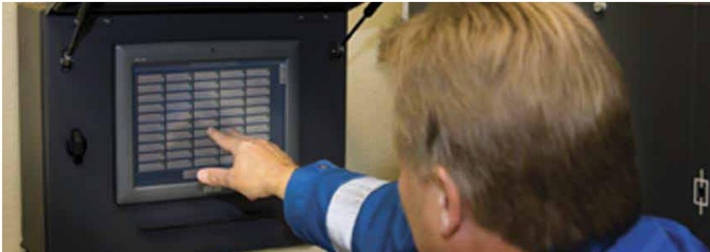
Устройство NM-CCU предназначено для удаленного управления до 300 коммутационными аппаратами. С его помощью можно управлять коммутацией выключателей, разъединителей, реклоузеров. А так же принимать, хранить и передавать данные, полученные от этих устройств. Является мощным и недорогим аналогом SCADA.
