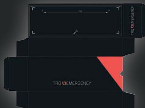
Разработан новый дизайн упаковки для продукции сегмента аварийного освещения. Соответствующее качество картона и конструкторские особенности макета коробок обеспечивают сохранность товаров при транспортировке, а также удобство складирования. Информация о товаре содержится на маркировке коробки и включает полное наименование, артикул продукта, штрих-код, дополнительные знаки. Упаковка выполнена в фирменном стиле суббренда LT EMERGENCY, что делает ее легко узнаваемой для потребителей.
