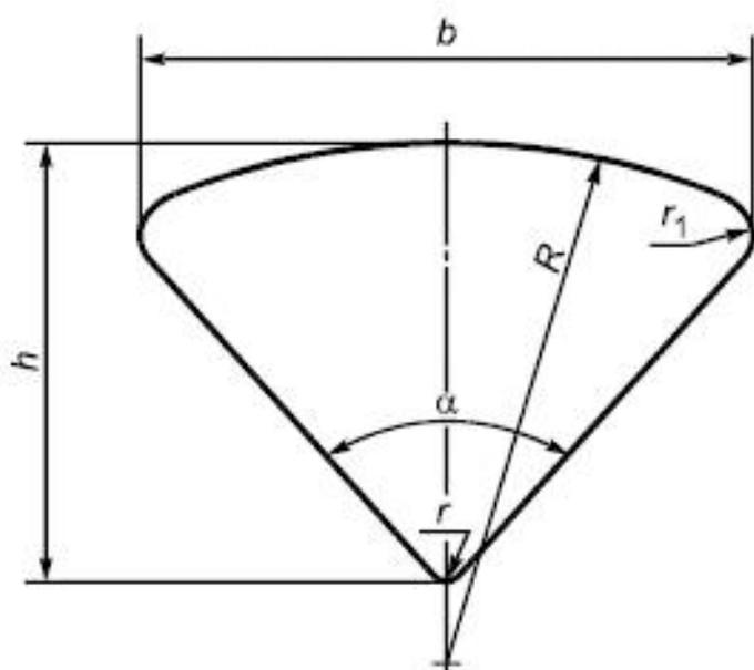
$r_1 \geq 0,5$  мм - радиус закругления
