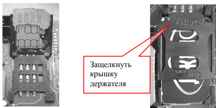
Рисунок 2. Установка SIM карты в держатель
