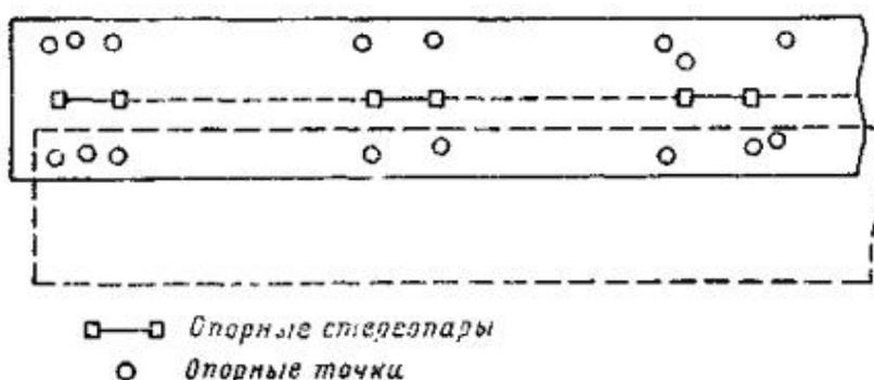
Рис. 2. Схема расположения опорных контурных точек
