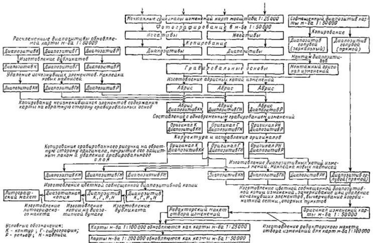
**Рис. 7. Схема технологии обновления карт всего масштабного ряда методом двойного копирования**
