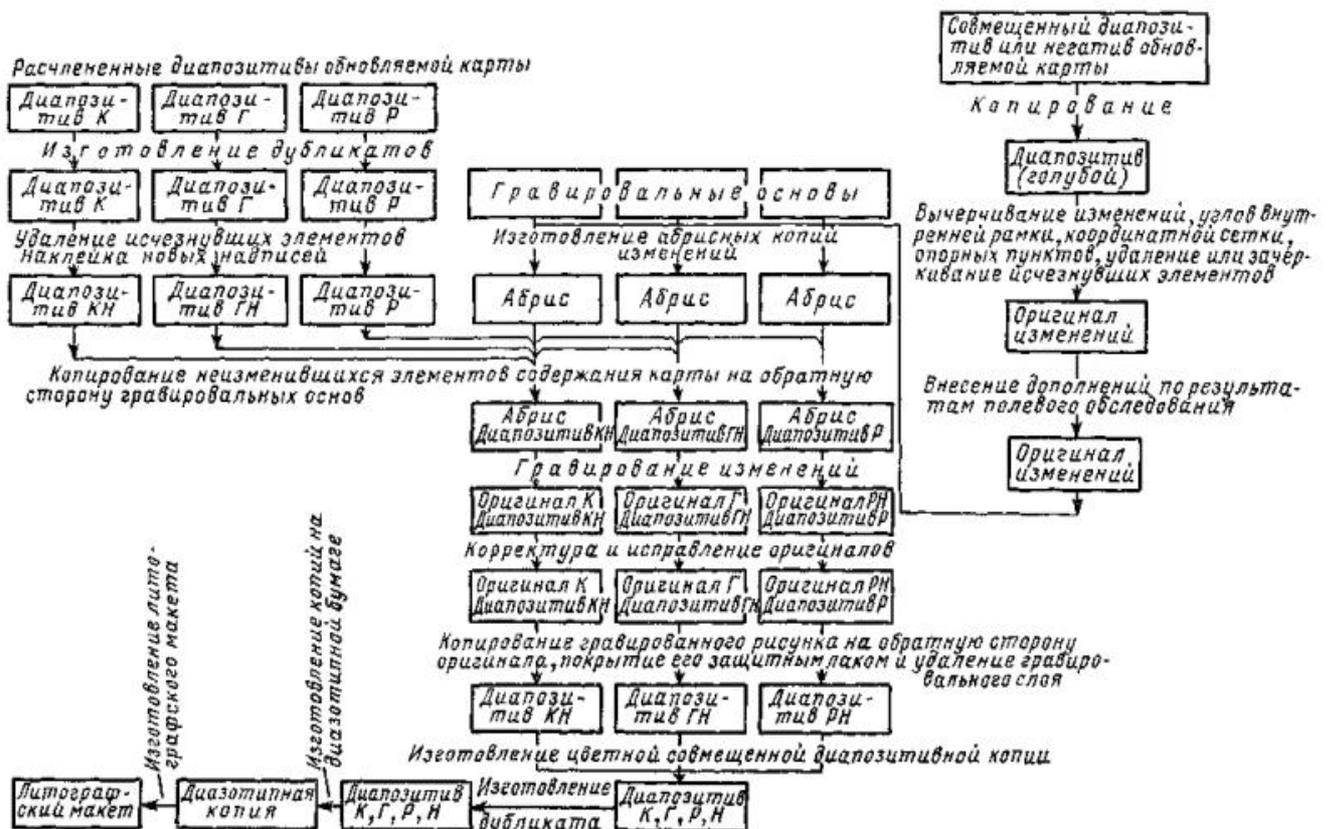
**Рис. 5. Схема технологии исправления составительских и издательских оригиналов методом двойного копирования**
