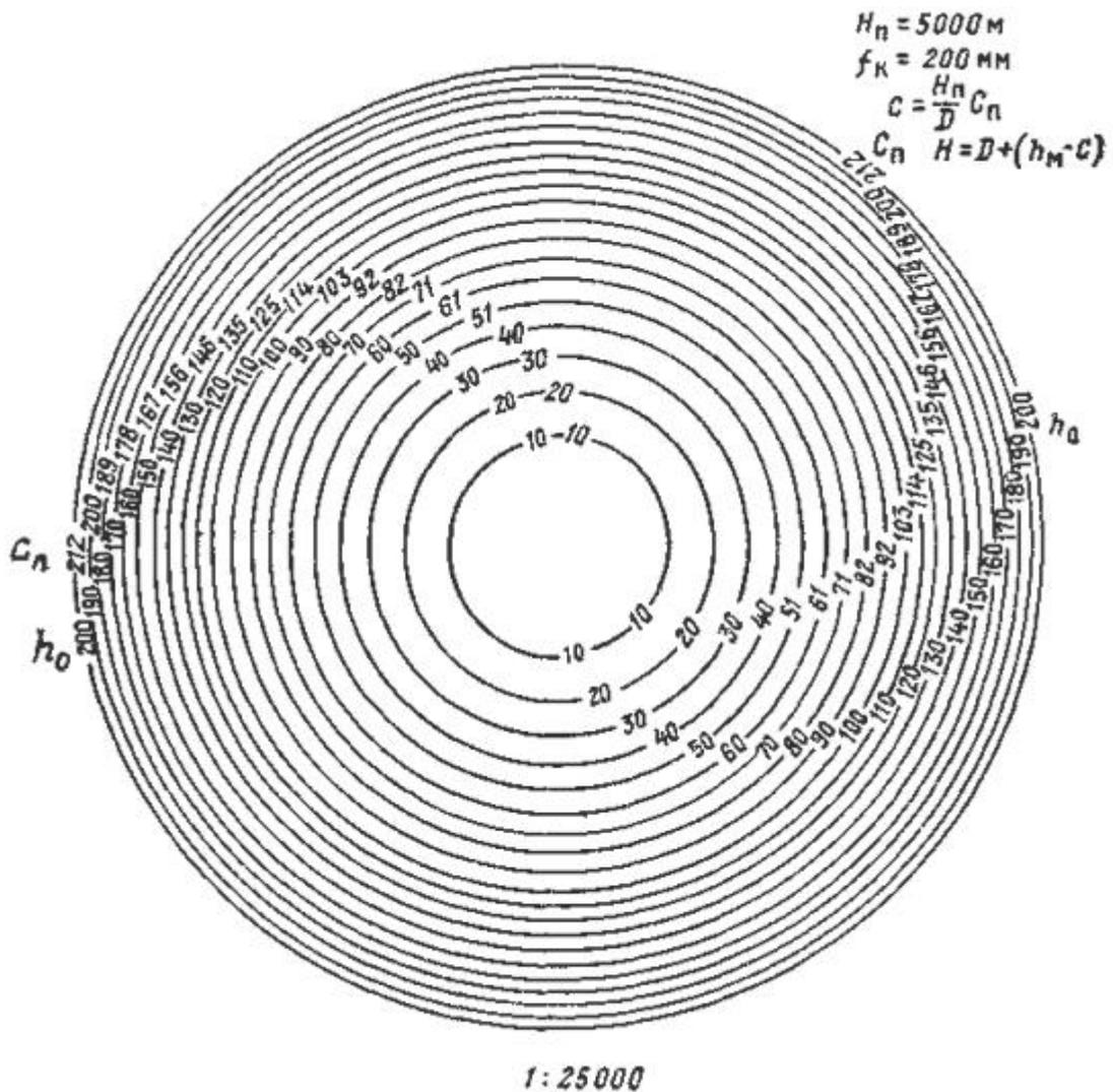
Рис. 3.2. Палетка для определения поправок в показания радиовысотомера
