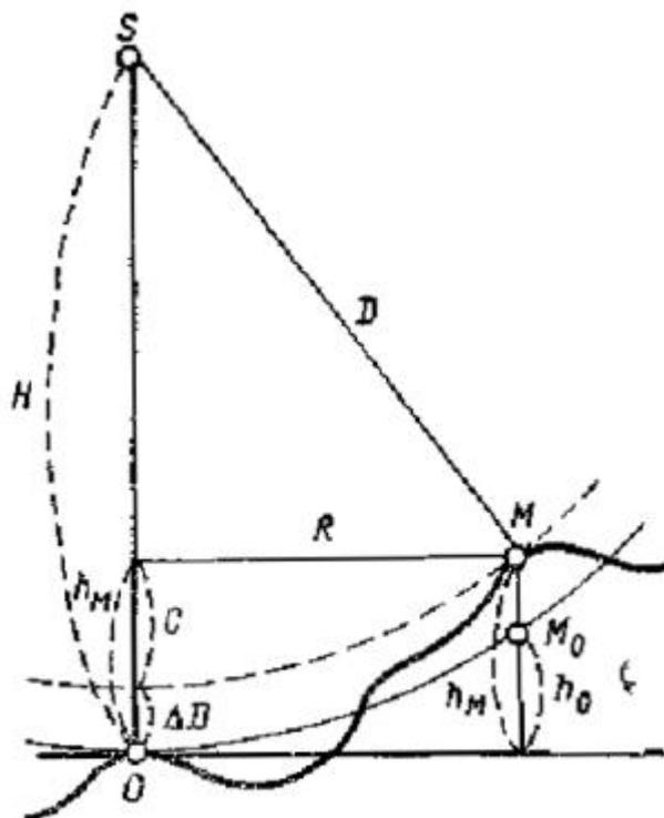
Рис. 3.1. Определение высоты фотографирования
