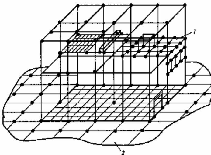
Рис. 4.7. Сетчатое заземляющее устройство здания:
