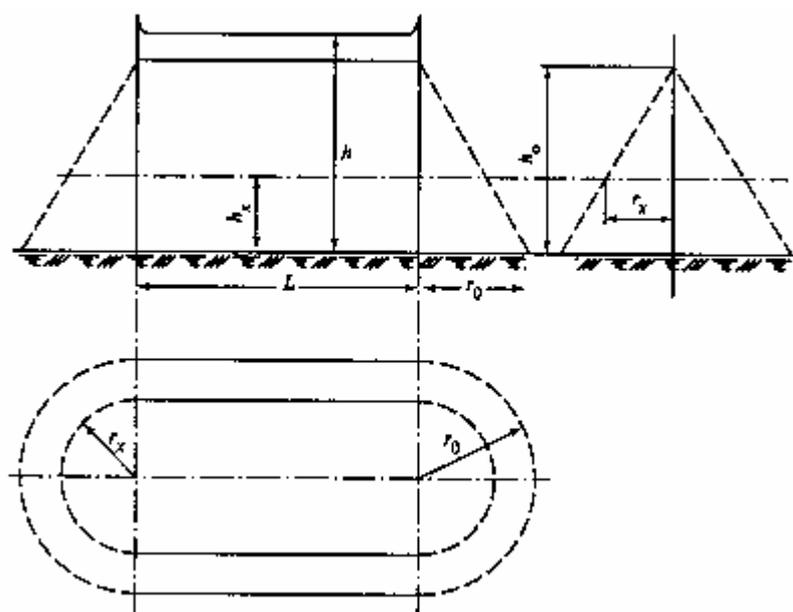
Рис. 3.2. Зона защиты одиночного тросового молниеотвода
