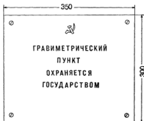
Приложение 5. Охранная плита гравиметрического пункта
