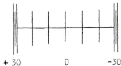
Рис. 11. Схема совмещения подвижного индекса маятника с делениями окулярной шкалы гравиметра при определении чувствительности маятника к наклону
