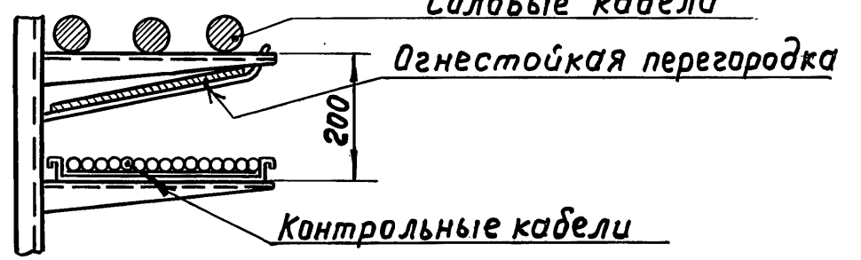
6. Установка огнестойкой перегородки
