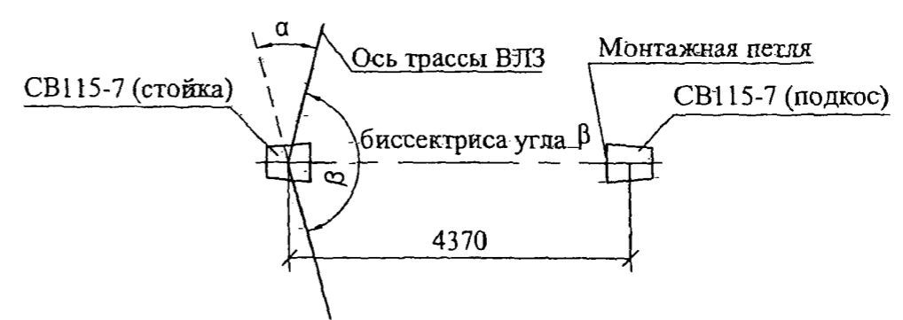
Схема установки стойки и подкоса
