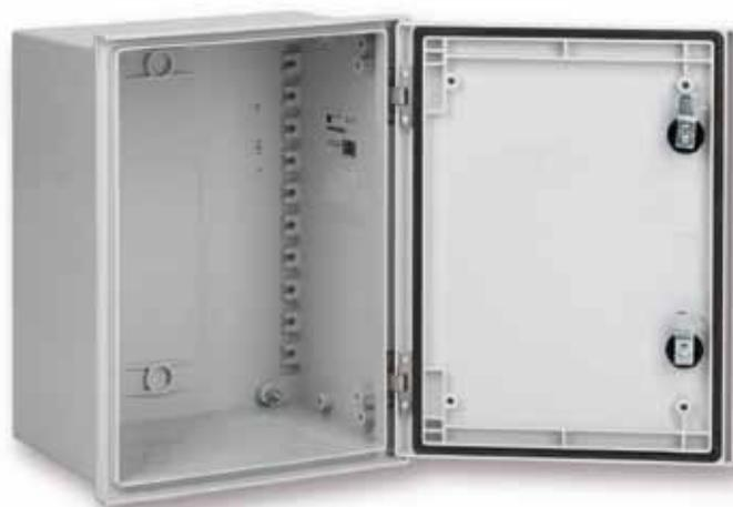
Настенные щиты Ensto Cubo N имеют встроенный защитный бортик, который позволяет открывать дверцу на 180° и защищает щит от попадания воды. Направляющие для быстрого монтажа на задней панели обеспечивают установку без сверления отверстий.
