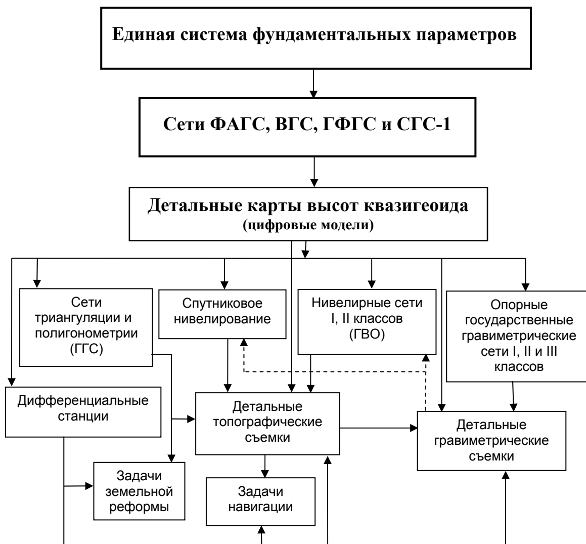
Рис. 3. Иерархическая структура системы геодезического обеспечения
