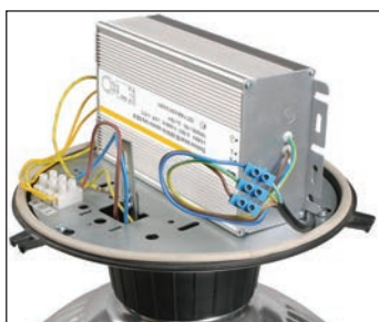
Шаг 3. Подключение ЭПРА для индукционной лампы
