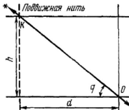
Рис. 5.1. Расчет «точки встречи» нити микрометра с изображением звезды
