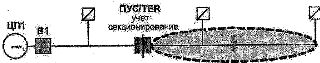
Рисунок 3 - Пункт секционирования линии с односторонним питанием с возможностью учета электрической энергии
