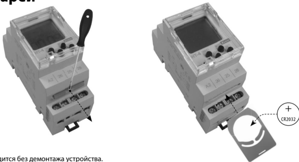
Замена батареи производится без демонтажа устройства.
