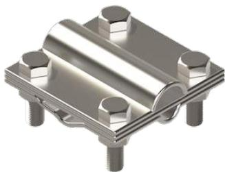
Зажим из нержавеющей стали позволяет соединить стержень заземления с круглым заземляющим проводником или полосой шириной до 40 мм. Промежуточная пластина из нержавеющей стали уменьшает коррозию соединения, исключая образование электрохимической реакции между разнородными металлами
