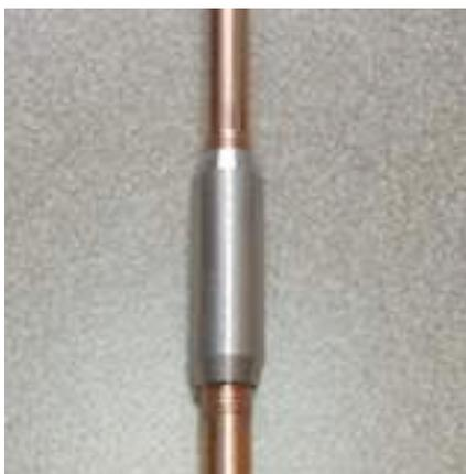
*Выкрутить болт направляющий, смазать смазкой антикоррозионной электропроводящей резьбу второго стержня и вкрутить его в соединительную муфту первого стержня.*
