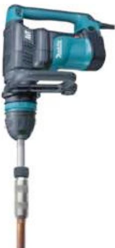
*С помощью кувалды либо перфоратора с насадкой SDS-тах заглубить первый стержень. При забивании кувалдой второму человеку необходимо придерживать стержень во избежании его колебания, чтобы удар кувалдой ложился ровно на плоскость болта направляющего. При косом попадании кувалды возможен разлом болта направляющего.*
