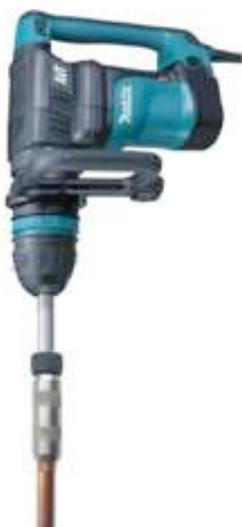
*Повторить пункты 3-5 данной инструкции до погружения в землю всех стержней комплекта (4 шт.) на глубину 0,5-0,7 м прямока. Выкрутить последнюю соединительную муфту (муфту для монтажа) с болтом направляющим.*
