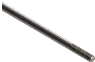
Стальной стержень диаметром 14 мм, медное покрытие которого толщиной более 250 мкм по всей длине стержня. Данное антикоррозионное покрытие не боится царапин и обеспечивает срок эксплуатации заземлителя до 50 лет.
