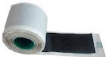
Лента используется для защиты соединения финишного стержня с заземляющим проводником от почвенной и электрохимической коррозии путем изолирования места соединения от воды (влаги), без которой процесс коррозии невозможен. При этом лента не теряет своих физических и механических свойств в течение многих лет.
