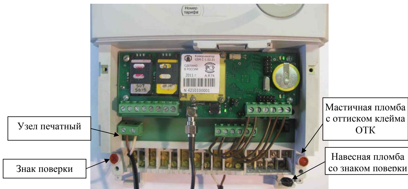
Рисунок 2 - Внешний вид отсека для установки дополнительных интерфейсных модулей
